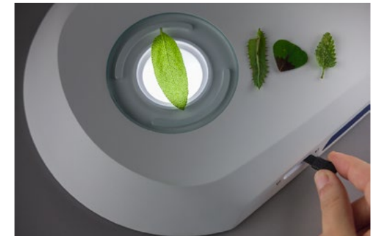
Verwenden Sie die flache Durchlichteinheit, um farbige, transparente Proben im Hell- und Dunkelfeld kontrastreich darzustellen. Fügen Sie die Polarisator-/Analysatorausrüstung hinzu, um zum Beispiel doppelbrechende Kristalle oder Spannungen in Glas oder Kunststoff zu beobachten.
