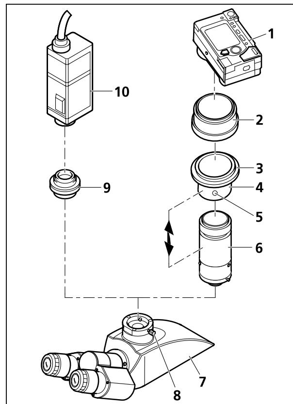
Figura 17 Fijar una cámara fotográfica
