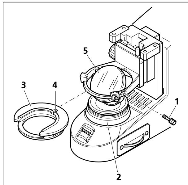
**Fig. 16 Pose et dépose du miroir**
