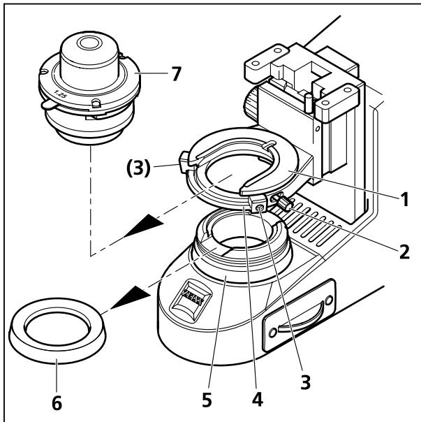
**Figura 15 Desmontar y montar el condensador**
