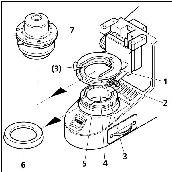
Рисунок 15 Демонтаж и монтаж конденсора
