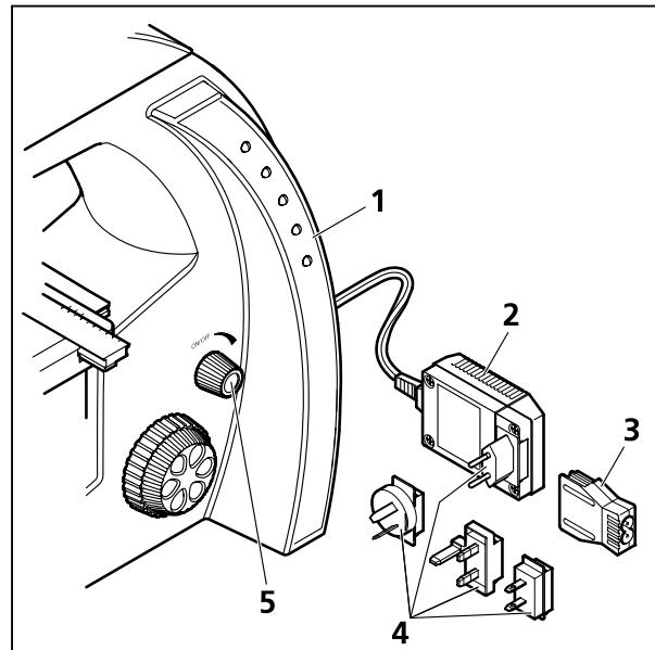
Рисунок 3 Ввод микроскопа в действие
