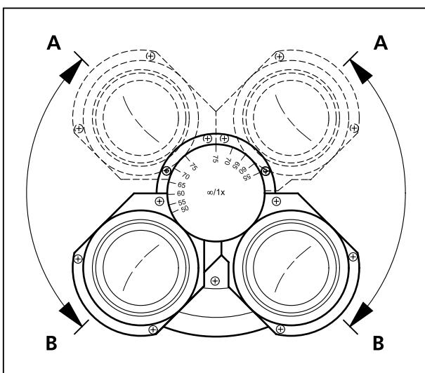
**Figura 6 Ajuste de la altura de observación**
