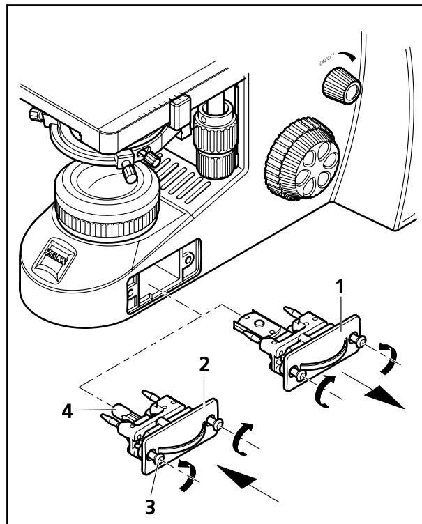
图13 更换 6 V / 30 W 卤素灯泡或发光二极管照明设备
