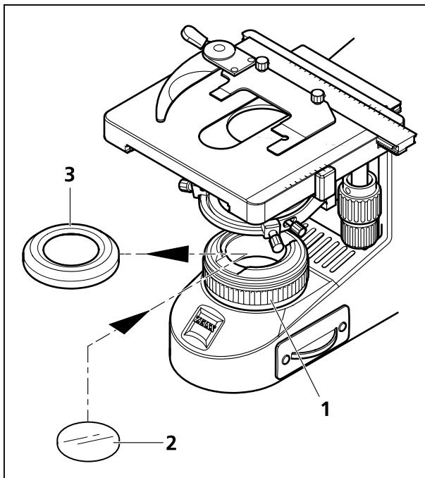
Bild 12    **Farbfilter einsetzen**
