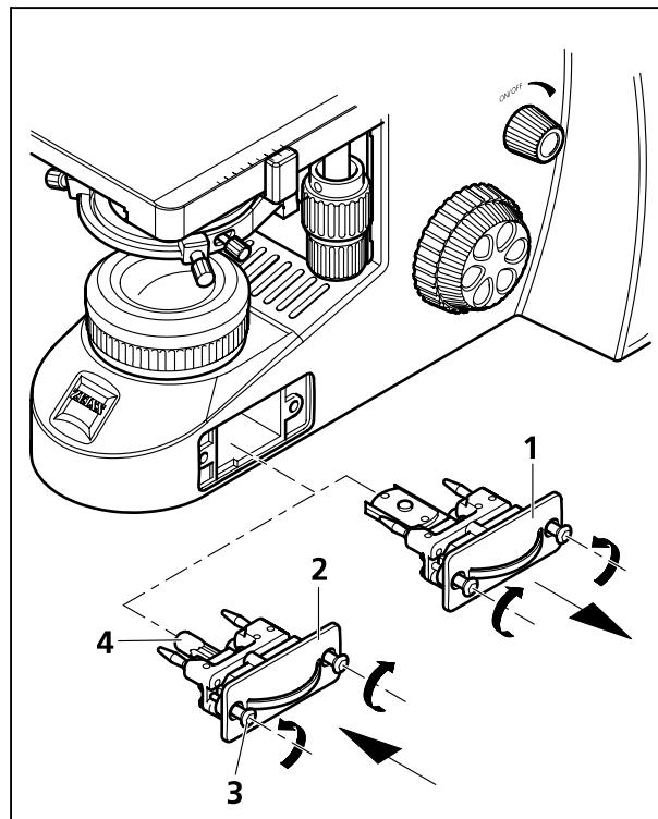
**Fig. 13** Remplacement de la lampe halogène 6 V / 30 W ou de l'éclairage LED
