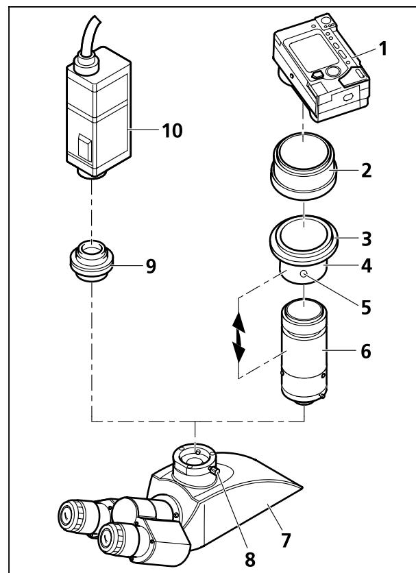
Fig. 17 Pose de l'appareil photo
