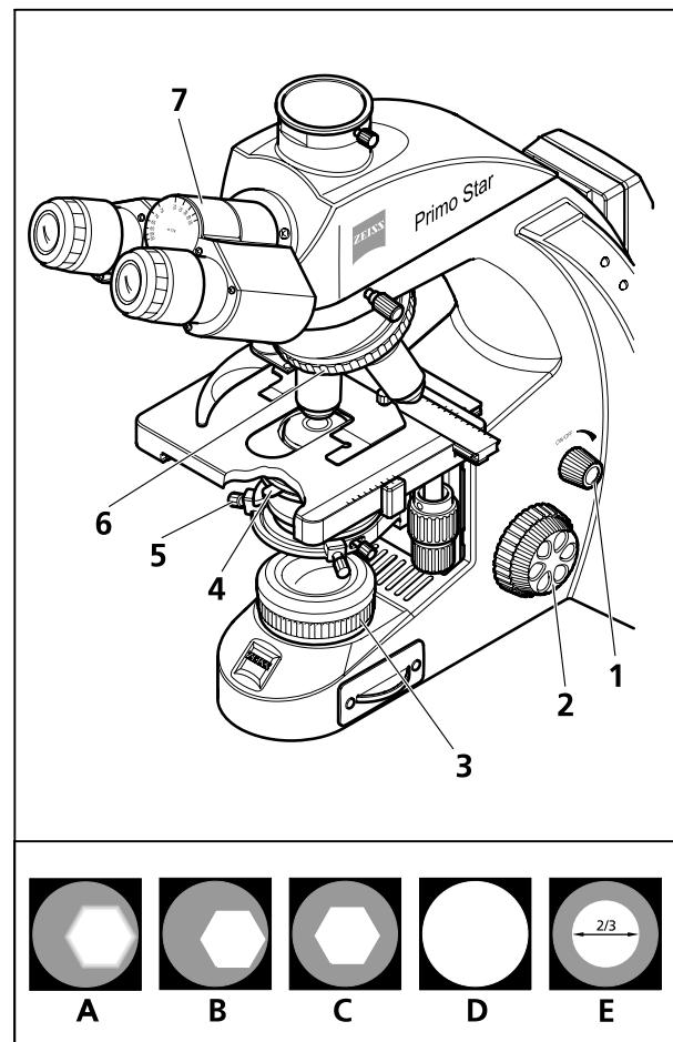
Рисунок 8 Настройка для работы в проходящем свете по методу светлого поля
