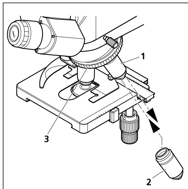
**Fig. 14** Remplacement d'un objectif
