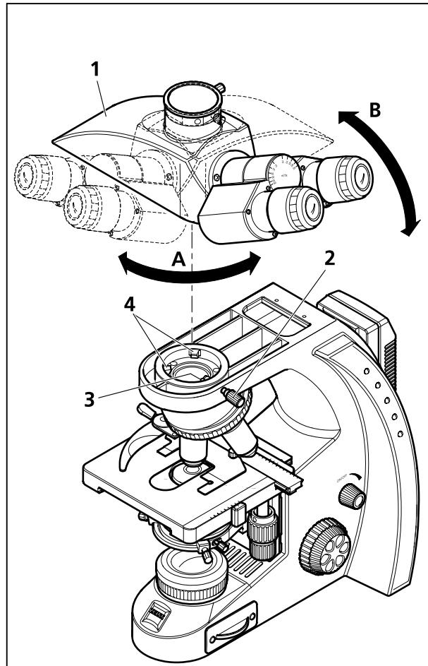
**Figura 11 Cambiar el tubo**
