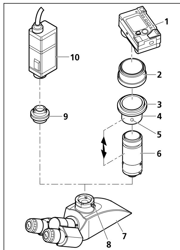
Рисунок 17 Установка фотокамеры
