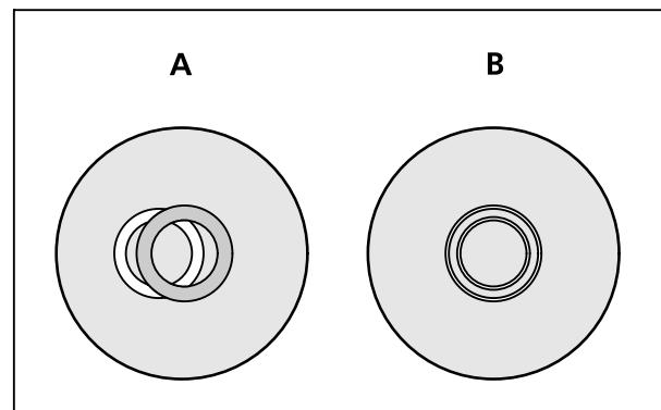
Рисунок 10 Центрировка кольцевой диафрагмы
