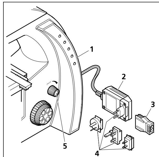
Figura 3 Puesta en servicio del microscopio
