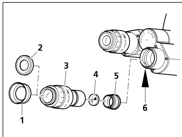
Bild 7 Okularzeiger einsetzen
