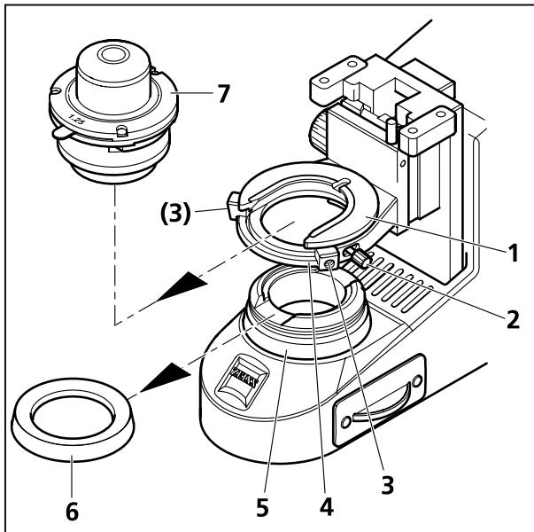
Bild 15 Kondensor aus- und einbauen
