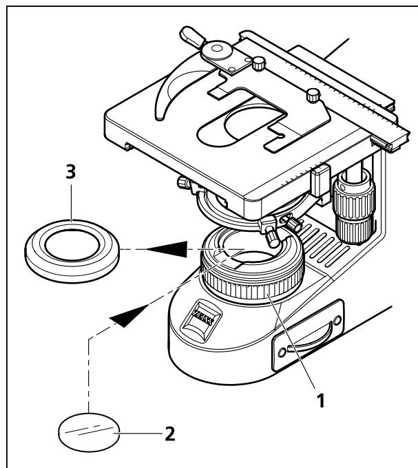
**Fig. 12 Insertion d'un filtre coloré**
