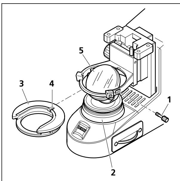
图16 安装和拆卸反光镜
