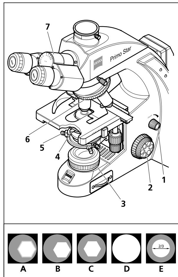
**Fig. 8 Réglage du fond clair en lumière transmise**
