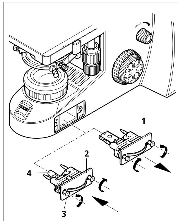
**Bild 13 Halogenlampe 6 V / 30 W bzw. LED-Beleuchtung wechseln**
