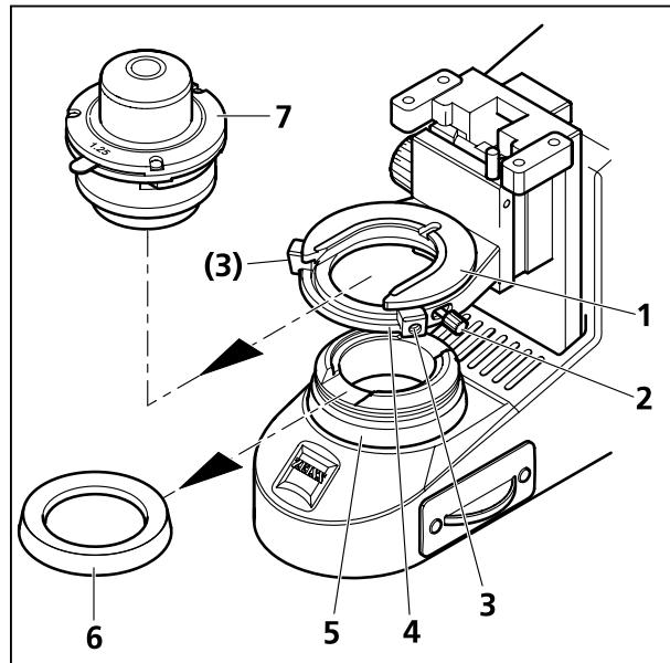
**Fig. 15 Dépose et pose du condenseur**
