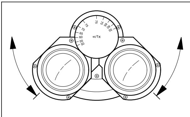
**Figura 5 Ajuste de la distancia entre los oculares**
