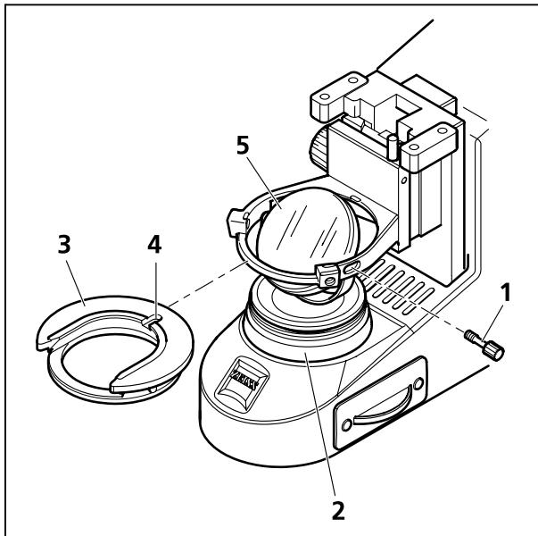
**Figura 16 Montar y desmontar el espejo**
