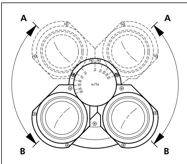
**Fig. 6 Réglage de la hauteur d'observation**
