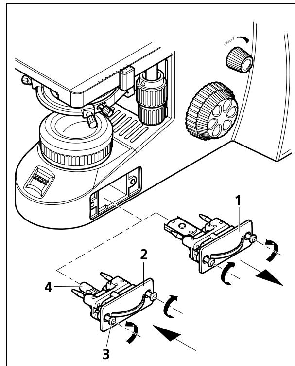
**Figura 13 Cambiar la bombilla halógena de 6 V / 30 W o sea el módulo de iluminación con LED**
