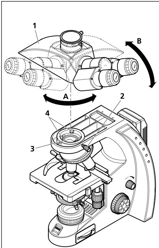
Bild 11    **Tubus wechseln****3.4****Mikroskop umrüsten**
