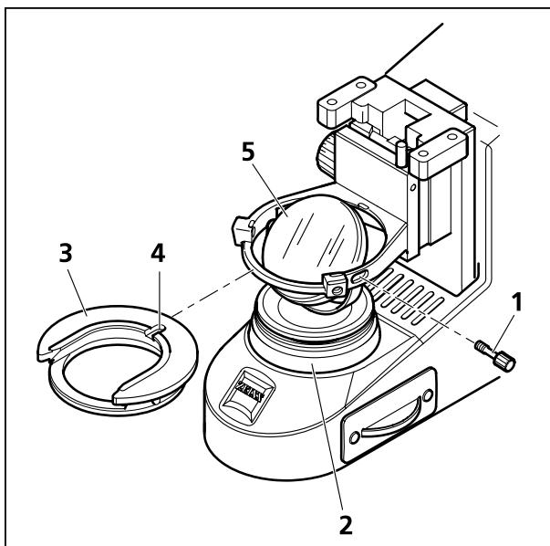
Рисунок 16 Демонтаж и монтаж зеркала
