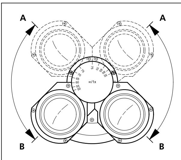
图6 设置观察高度
