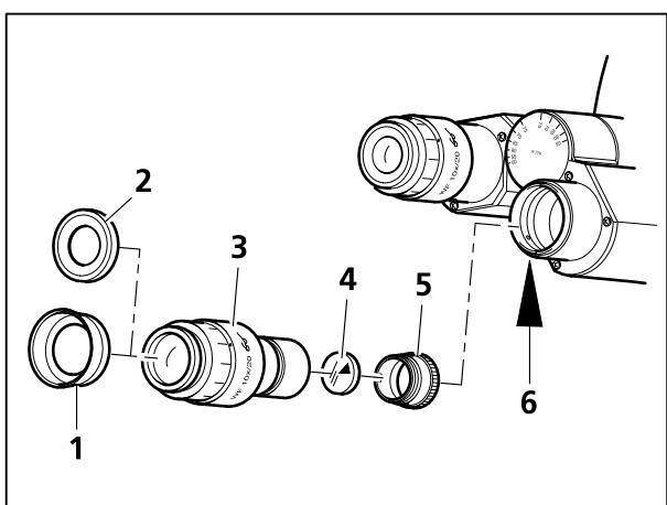
**Fig. 7 Mise en place du réticule de mise au point**
